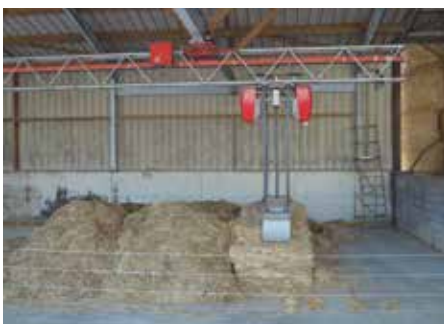
■ Tres robots utiliza De L' Epinay: uno suministra heno, otro alimento automatizado y otro se encargan de la limpieza.
